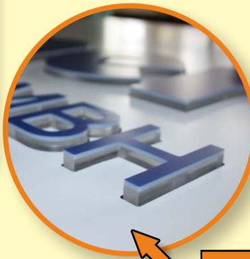
CNC gefräste Einzelbuchstaben durchgesteckt in dekupierter CNC gefräste Alu-Dibond Haube
